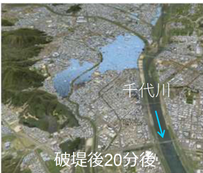
浸水ナビのデータを用いた時系列での浸水シミュレーション可視化事例（鳥取県鳥取市）
