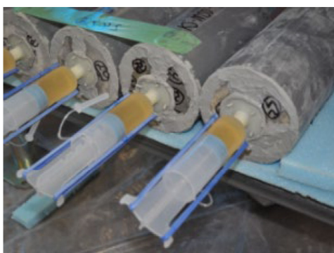
割裂ひび割れを入れた \phi 10 \times 20 cm円柱供試体に 樹脂系注入材を注入
