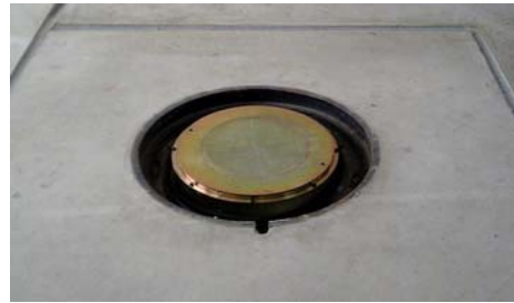
写真2 荷重計校正用ロードセル
