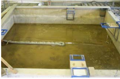
①水槽内に0.1~2mmの混合砂を敷き詰め、排砂管を堆砂表面に設置
