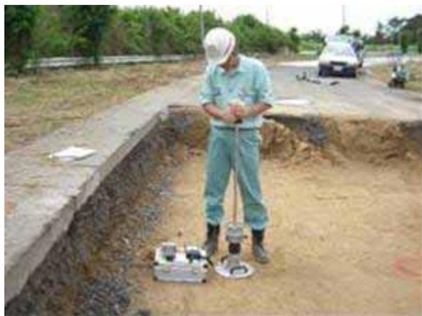
写真-5.1 動的平板載荷試験状況
