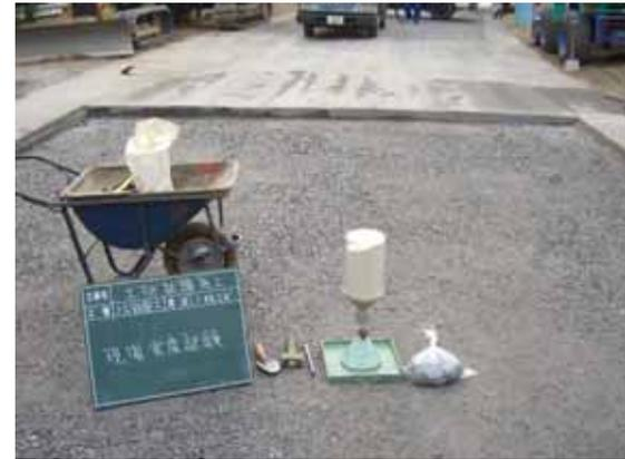
写真-5.5 現場密度試験(上層路盤)
