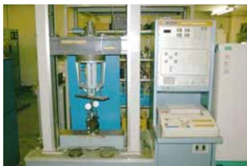
図-2.4 圧裂試験による測定項目と測定状況
