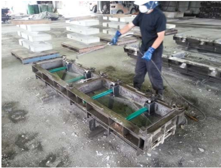
写真-6.3 剥離剤塗布状況
