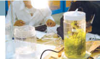
DOメーターで水草の酸素生産量を測定しているところ。光を当てることで生産量を増加させる。
