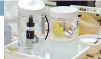
溶存酸素を計測する機器(DOメーター)を用いて魚の酸素消費量を測定してるところ。
