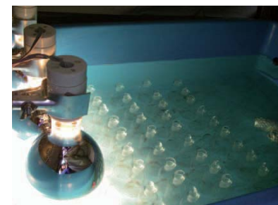
写真1 明暗瓶法による光合成速度の測定
