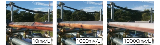
写真1 実験で用いた管路を流れる各濃度の濁水
