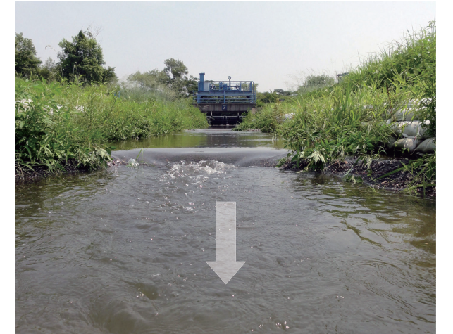
写真1 瀬淵工の大型模型実験
