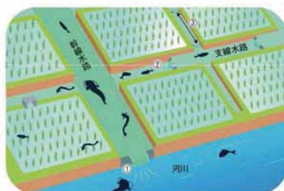
①河川合流部の落差 ②水路内の落差 ③落差に挟まれた水路長 図2 落差による水路の分断
