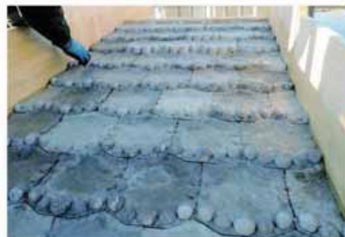
図1 実験に用いた魚道模型
