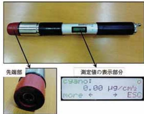
図1 今回使用した携帯機器の全体および先端部
