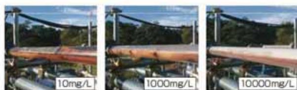
写真1 実験で用いた管路を流れる各濃度の濁水
