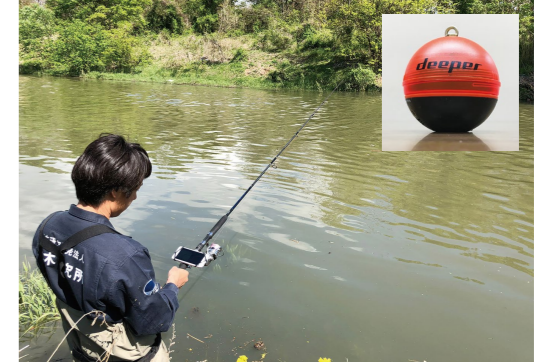
図1 携帯型ソナーと受信機となるスマートフォン
