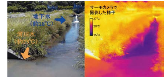
図1 河川水と地下水の合流点とサーモカメラで撮影した様子
