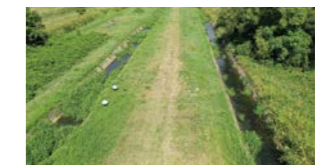
上流ゾーン 河岸をコンクリートで覆い、かつ直線形状にすることで、流れの速い区間ができます。ここでは、川底の石についた藻の洪水による剥離に関する実験や、流れが川底を動かす力について研究を行っています。(河床勾配: 1/200)
