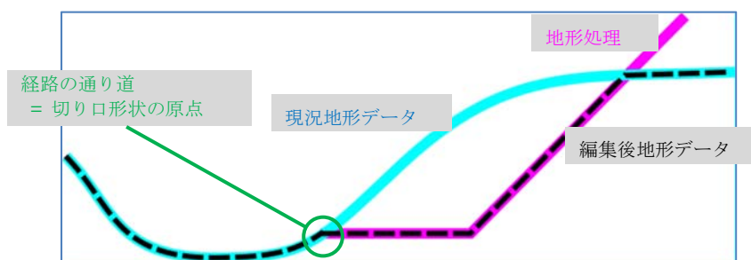
図 8 「地形データ」編集 イメージ図（河川横断面）
