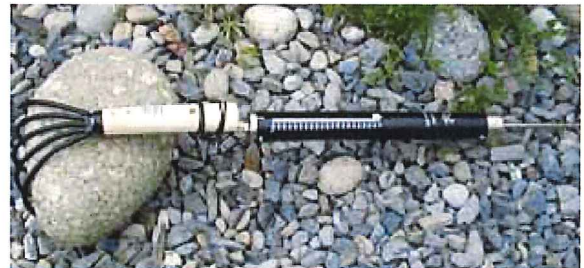
写真-1 河床固化の測定装置。ばねばかり(置針式丸型テンションゲージ、(株)大場計器製作所製)と熊手にて作成。径 10 cm 程度の礫には 100 N 程度の秤量が必要であること(高尾ら, 2003)から、ここでは秤量 200 N (最小 2 N)で瞬間最高値を計測可能な置針式を採用。
