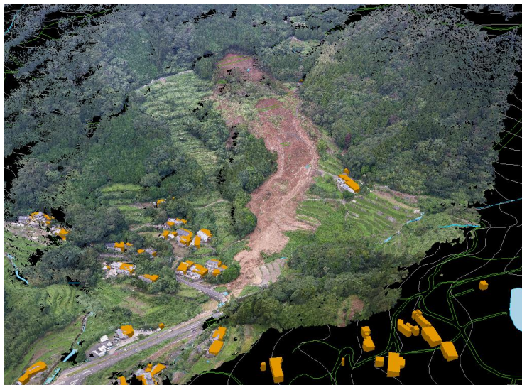
地すべり災害対応のBIM/CIMモデル
