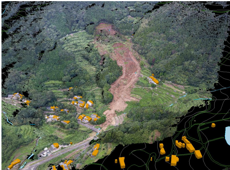
地すべり災害対応のBIM/CIMモデル
