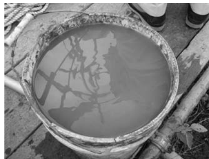
写真 3.3 孔内の濁り水
