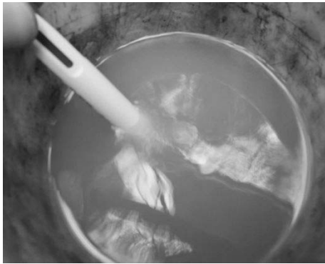
写真 3.4 洗浄時の戻り水の濁り状況
