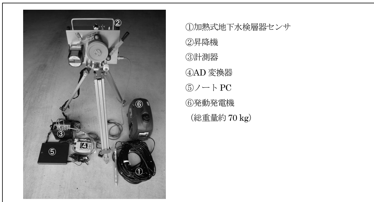
図 解 3 - 1 1 加熱式地下水検層器の機器構成
