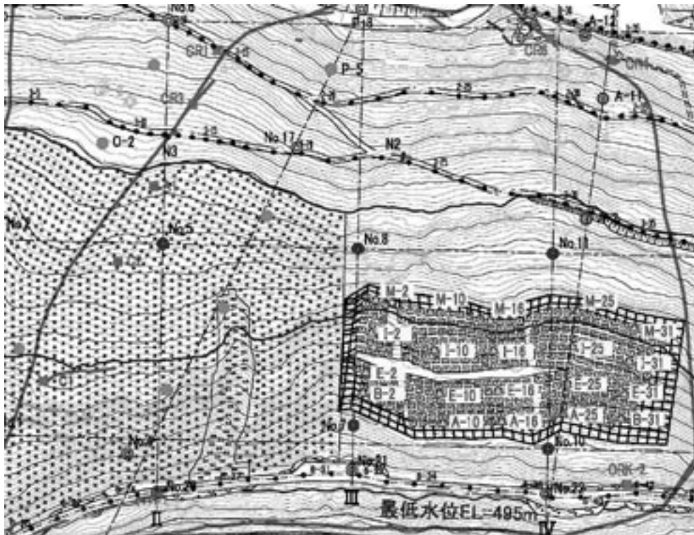
図 2. 4. 12 再調査後の1次すべりとアンカー工
