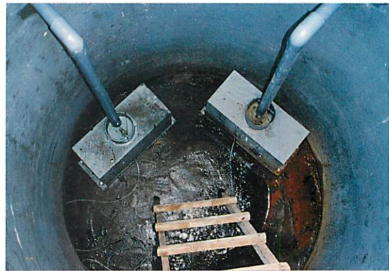
▲バケット式流量計 Bucket type discharge measure
