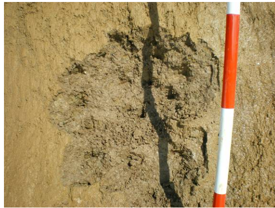
写真-37 滑落崖露頭の砂混じり粘土
