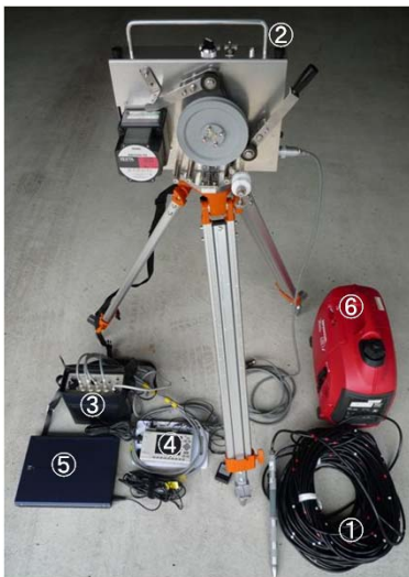
▲写真-1 加熱式地下水検層に用いる機材
