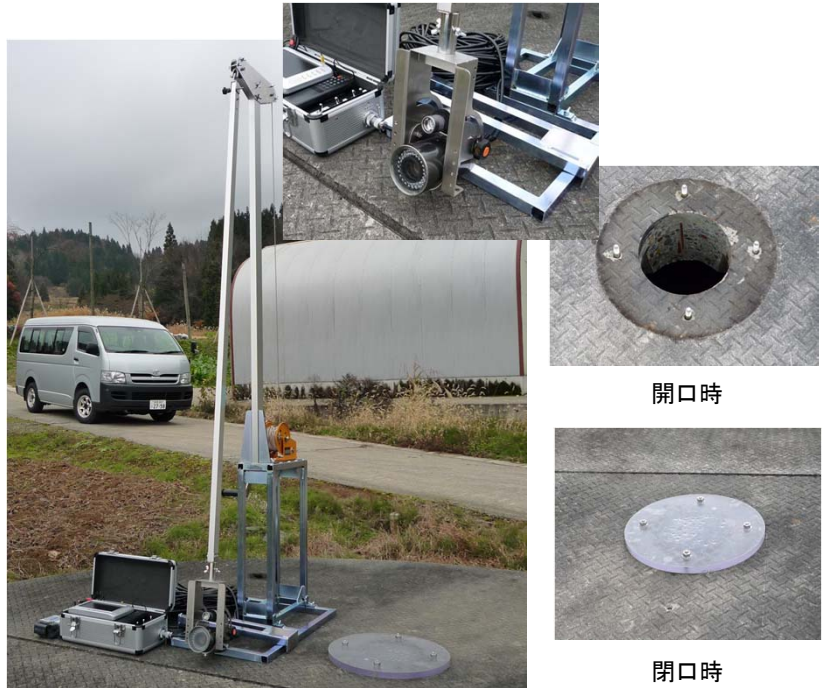
▲写真-1 集水井内点検用カメラ
