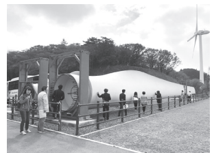
2,000kW 風車のブレード
