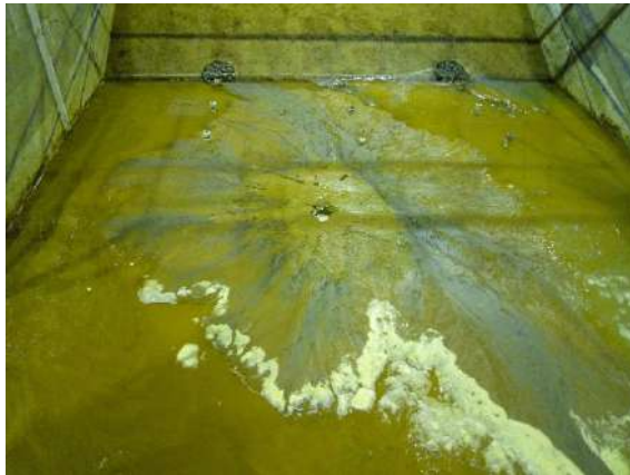
(a) 実験後の盤膨れの状況
