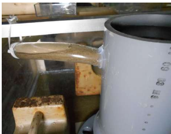
(a) 対策工の外まで詰まった砂
