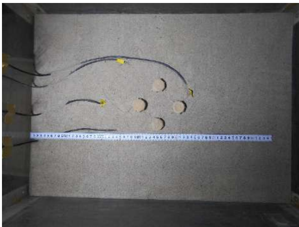
(c) 間隙水圧計の設置
