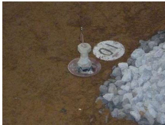
(c) 地表面に設置した錘
