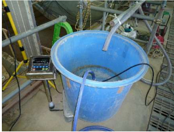
図 2-11 排水量計測状況
