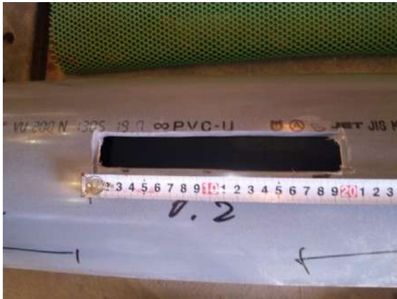
(a) 給水塩ビ管スリット加工部
