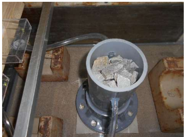
(f) 碎石の投入
