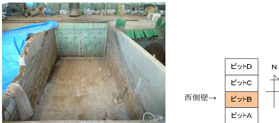
図 2-2 実験土層（ピット B）
