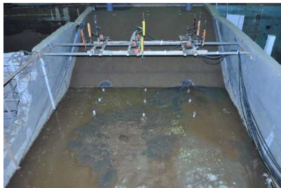
(e) 噴砂漏水(9 時間 50 分)
