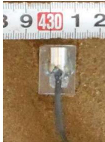
写真 2. 26 間隙水圧計
