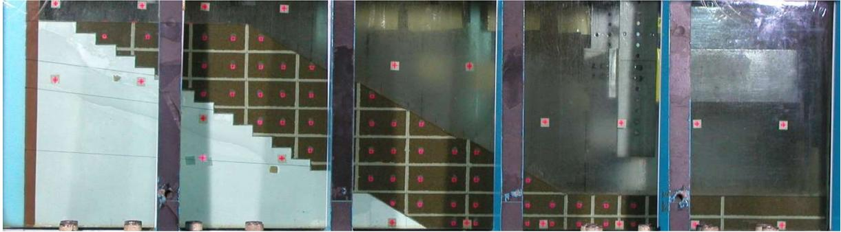
写真 2.6 石膏と地盤材料を用いた地山
