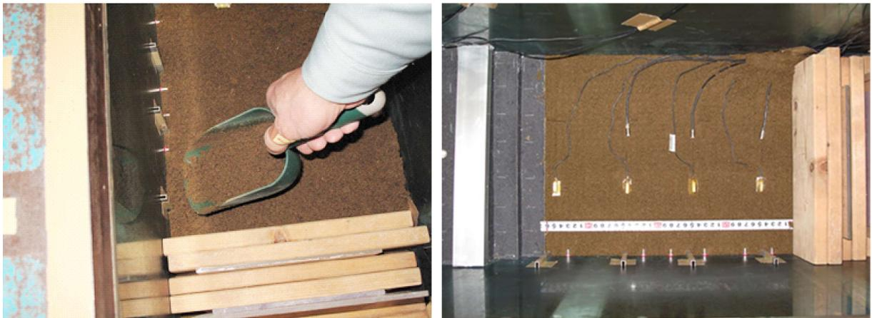
写真 2.7 地盤の作製状況の例
