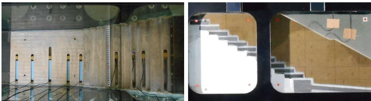
写真 2.5 アルミ材と石膏を用いた地山
