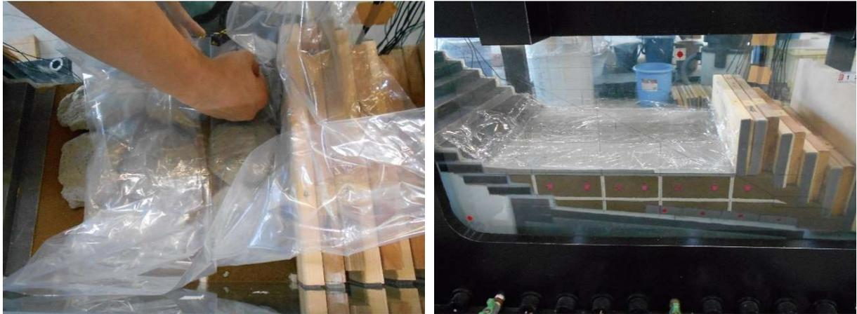
写真 2.8 難透水層の作製状況の例
