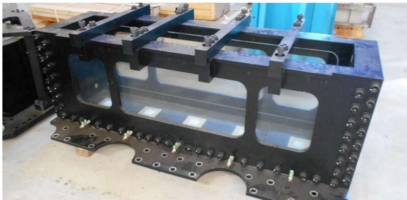
写真 2.2 動的大型土槽（幅 1500mm，奥行き 300mm，高さ 500mm）
