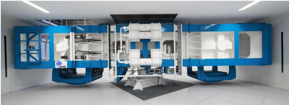
写真 2.1 大型遠心力載荷試験装置
