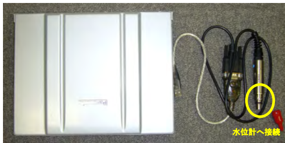
写真 B-2 RS485/RS232C コンバータケーブルとパソコン
