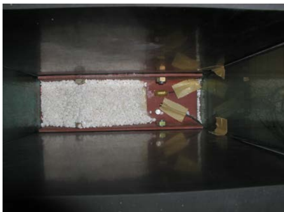
(i) 砕石層の作製状況
