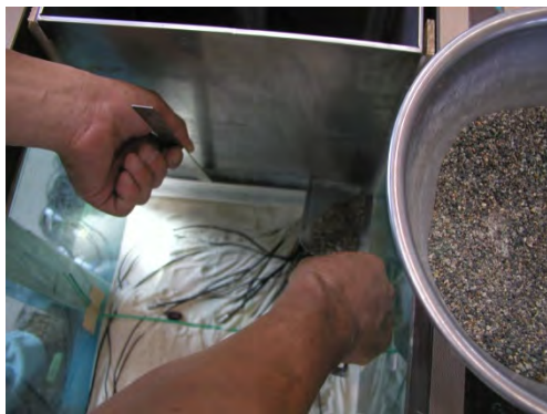
(a) 境界部の鉛直ドレーンの作製状況
