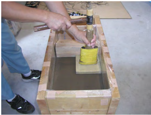
(a) 堤体の作製状況
