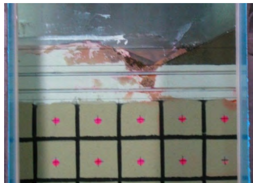
(d) パイピング箇所の横断面形状
