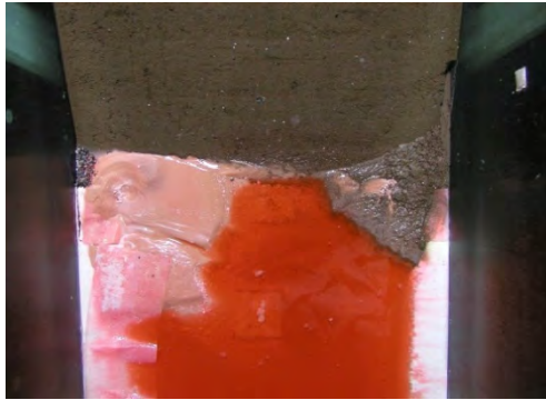
(a) 噴砂・パイピングの平面形状
