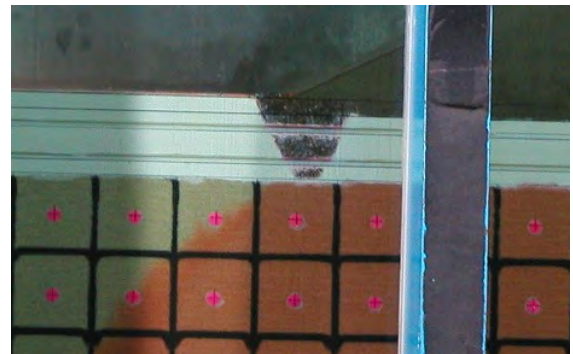
(e) 実験後の模型横断面形状
