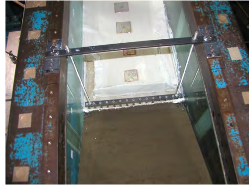
(b) 有孔管と設置状況
