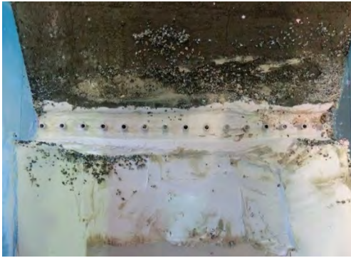
(a) 実験後の平面形状 (掘削)
