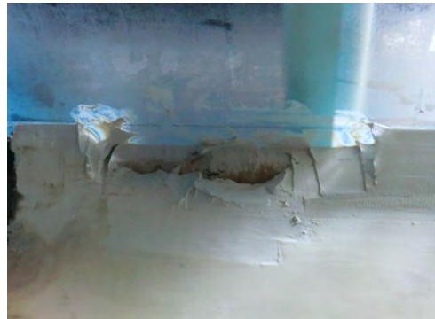
(d) 噴砂痕1の平面形状 (掘削)
