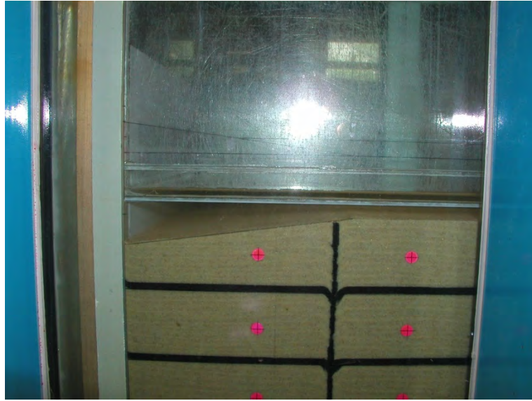
図-2.2.11 土槽ガラス面に付けた水みち形成防止用のアクリル棒
