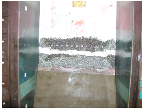
(c) 設置した有孔管
