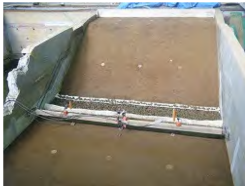
(f) トレンチ（堤内側）設置完了
