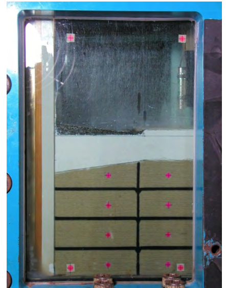
(c) 排水槽前面のドレーン（左：上から撮影、右：側面から撮影）
