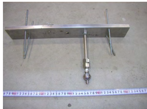
(d) 給水槽内の電磁弁
