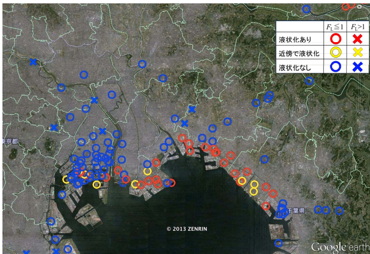
図-3.2 液状化判定実施箇所の液状化の有無と判定結果（東京湾北部詳細）
