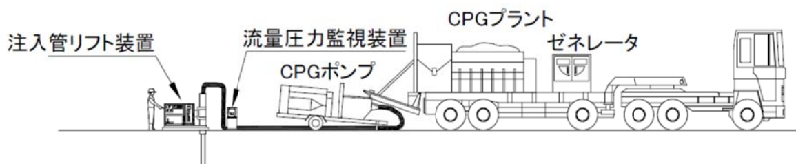
図-9.2.15 コンパクショングラウチング工法の施工機(車上プラント方式の場合)
