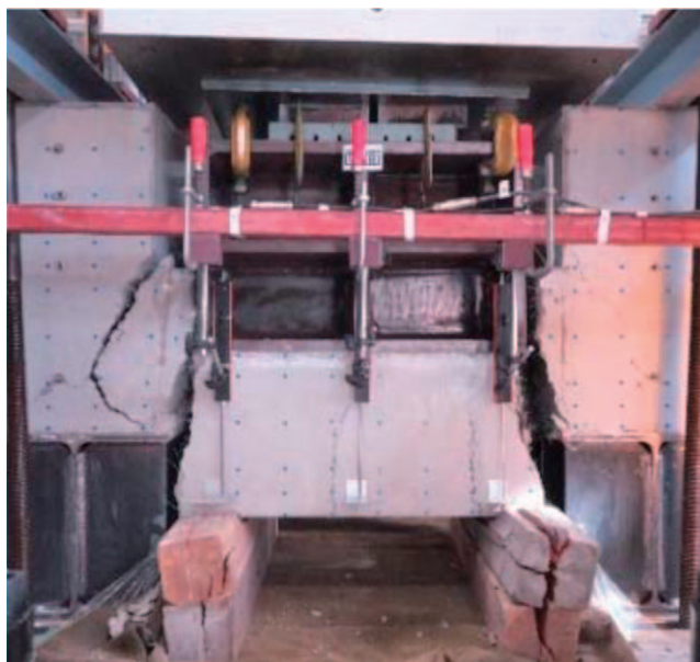
写真 6.5.1 要素実験における鋼繊維補強コンクリートの破壊状況 65.1)
