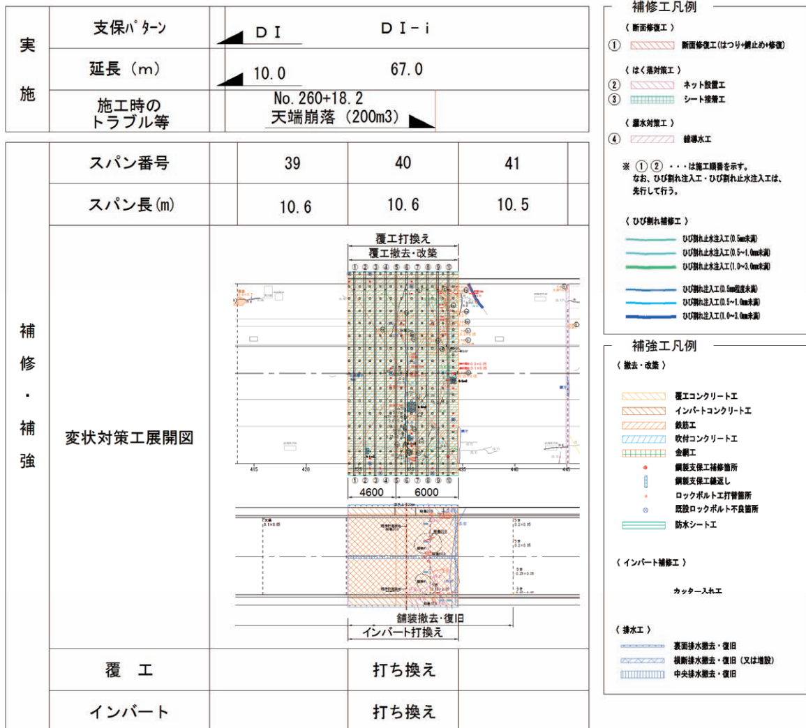
図 3.3.10 変状対策工 (スパン 40)
