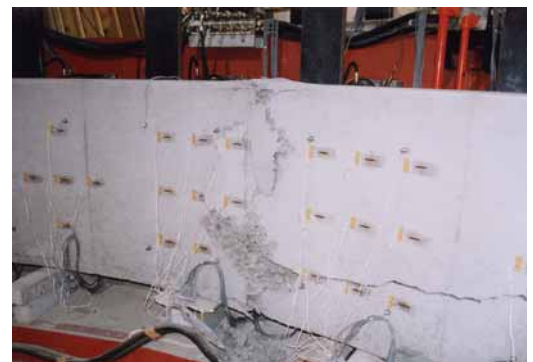
写真-3.3 圧ぎによる破壊の状況の例
