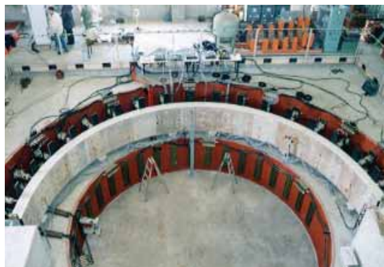
写真-3.2 覆工コンクリートの載荷実験
