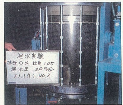
高圧力差2kgf/cm 2 での泥水実験
