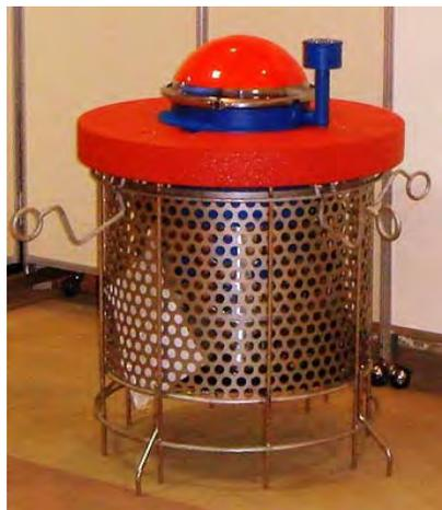
図 4.10 投下型水位観測ブイの外観
