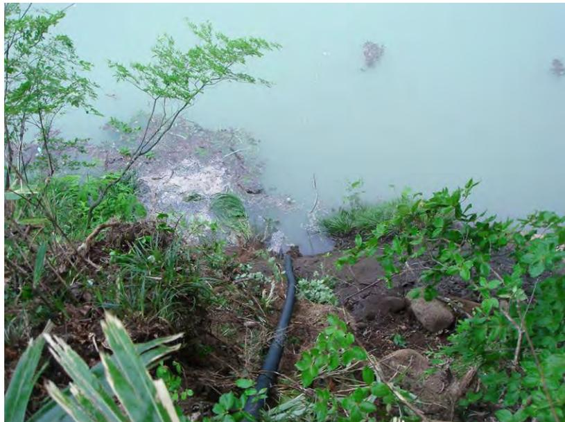
図 4.9 水圧式水位計設置事例
