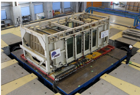
大型振動台と大型剛土槽
