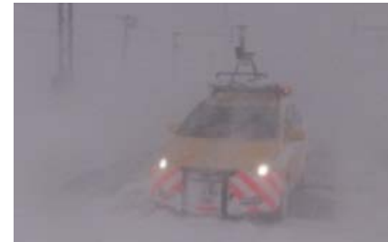
▲吹雪危険箇所を特定するために使用する視程障害移動観測車
